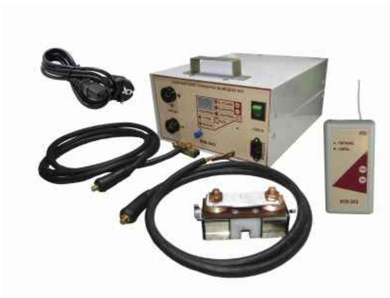
В аппарате контактной приварки выводов электрохимзащиты КПВ-ЭХЗ используется принцип конденсаторной приварки. Приварка специальных кабельных наконечников (выводов ЭХЗ) осуществляется за счет горения дуги и плавления конца наконечника.
