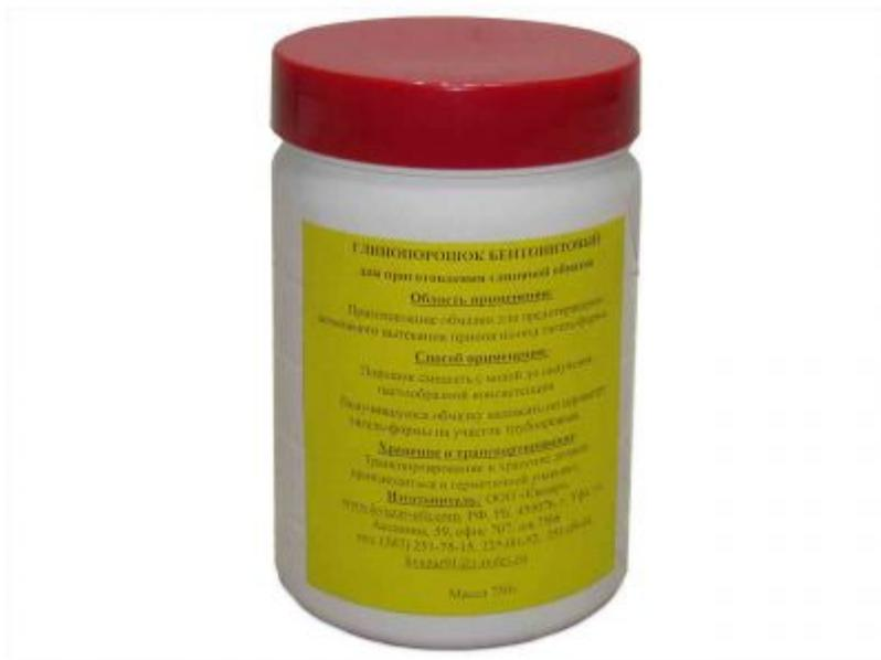
Бентонитовый глинопорошок предназначен для приготовления глиняной обмазки. Обмазка является необходимым элементом процесса термитной приварки выводов электрохимзащиты. Она позволяет защитить место стыка многоразовой тигель-формы и ремонтируемой части трубопровода от вытекания припоя.
