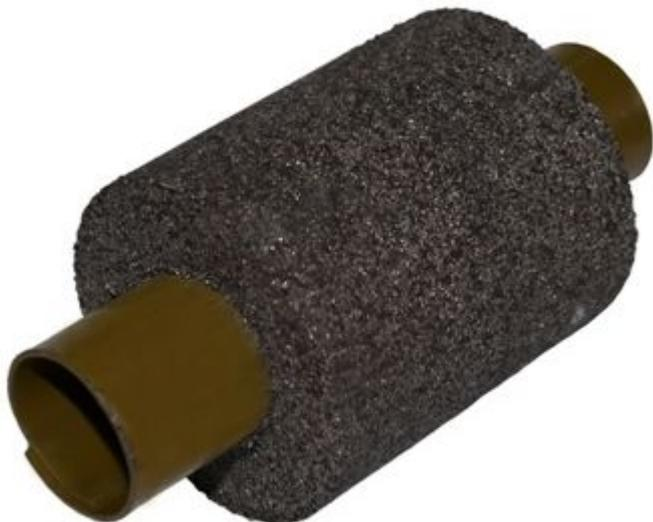
Термитные патроны ПАС (термопатроны) предназначены для сварки алюминиевых и сталеалюминиевых проводов воздушных линий электропередач. В зависимости от сечения свариваемого провода предлагается 14 видов термопатронов диаметром 16 до 600 кв. мм.
