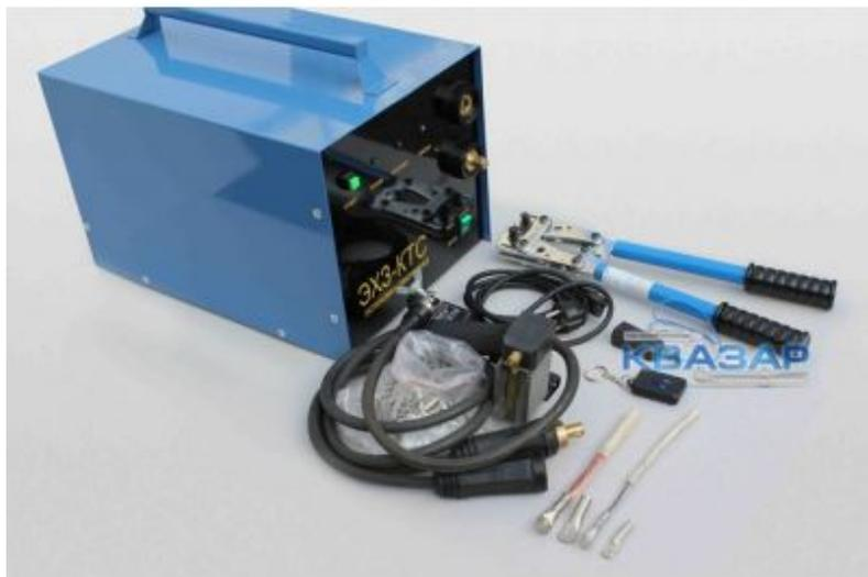
Мобильная установка ЭХЗ–КТС (ТУ 3441–005–27451073–2011) предназначена для приварки наконечников с выводами кабелей электрохимической защиты к телу магистральных газо- и нефтепроводов, продуктопроводов, а также к любым другим металлическим поверхностям в стационарных или полевых условиях.
