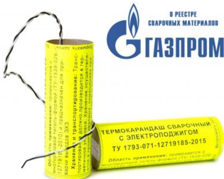
Термокарандаш сварочный представляет собой изделие в форме цилиндра, имеющего медную оболочку, заполненную специально приготовленной термитной массой. Отличительной особенностью данного термитного карандаша является наличие электроподжига. Т.е. воспламенение происходит за счет электрического сигнала, инициируемого, например, Устройством дистанционного поджига УДП-М.
