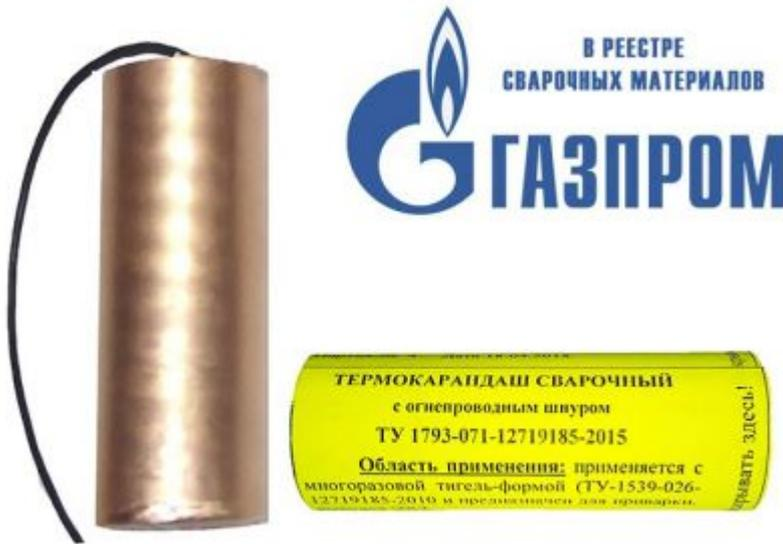
Сварочный термитный карандаш представляет собой изделие в форме цилиндра, имеющего медную оболочку, заполненную специально приготовленной термитной массой и предназначен для приварки стальных и медных выводов ЭХЗ к стальным магистральным трубопроводам.
