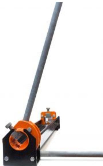
Инструмент для скручивания проводов МИ-230, а также его аналоги, предназначен для осуществления монтажа проводов в овальных алюминиевых соединителях марки СОАС (по ГОСТ 839-80 сечением 50 - 185 мм<sup>2</sup>) линий электропередач (воздушных), которые монтируются скручиванием (гр. УХЛ 1 по ГОСТ 15150-69) и производится в УХЛ - климатическом применении категории размещения 1.
