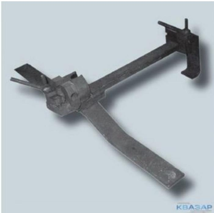
Предназначен для монтажа голых сталеалюминиевых проводов сечением от АС10 до АС35 в овальных соединителях типа СОАС.
