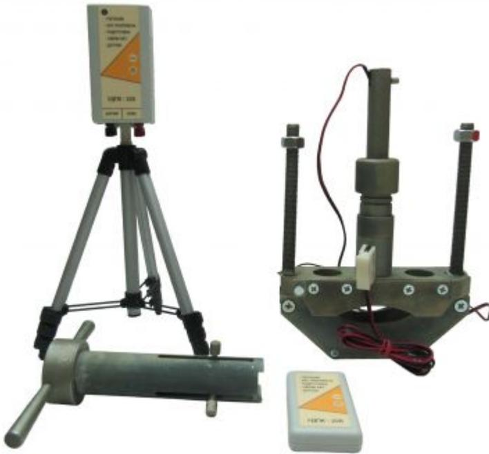
Устройство дистанционного прокола кабеля УДПК-90 предназначено для индикации отсутствия напряжения на ремонтируемом электрическом кабеле до 220 кВ перед его разрезкой, путем прокола кабеля по диаметру и замыкания жилы на землю, с целью предотвращения возможности поражения персонала электрическим током.
