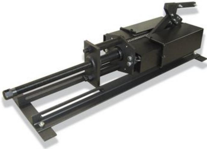
Устройство механического прокола кабеля УМПК предназначено для обеспечения условий электрической безопасности при работе с высоковольтными (до 35 кВ) кабелями. С помощью УМПК осуществляют закорачивание жил кабеля между собой и на землю. УМПК может быть использован при проколе кабеля с диаметром до 65мм. Особенностью устройства является его простота конструкции и портативность, а также легкость в эксплуатации и обслуживании.
