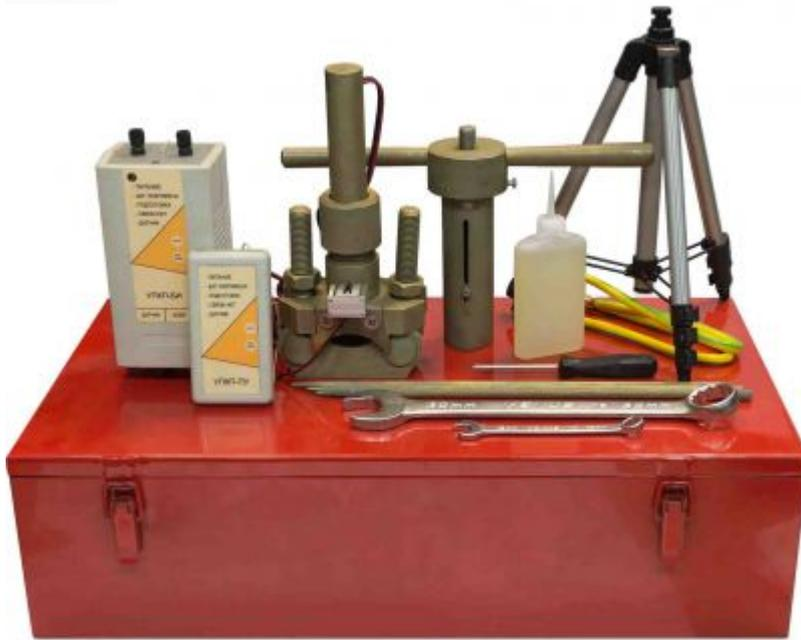
Устройство дистанционного прокола кабеля УДПК предназначено для индикации отсутствия напряжения на ремонтируемом электрическом кабеле до 220 кВ перед его разрезкой, путем прокола кабеля по диаметру и замыкания жилы на землю, с целью предотвращения возможности поражения персонала электрическим током.
