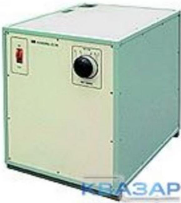
Установка прожигающая УП-7 предназначена для прожигания повреждений изоляции силовых кабелей с целью создания низкоомного проводящего мостика между жилами кабеля или жилой кабеля и защитной металлической оболочкой для последующего поиска места повреждения. УП-7 имеет ручное переключение ступеней выходного напряжения.
