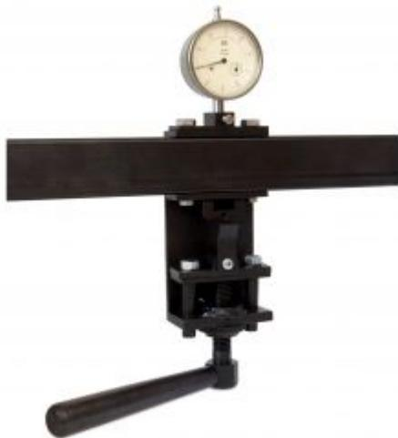
Прибор контроля натяжения троса ИНТК-4 предназначен для измерения и контроля величины усилия натяжения провода или троса при монтаже и эксплуатации ЛЭП, а также усилий в: оттяжках опор ВЛ (не реже 1 раза в 6 лет), соответствие с Правилами технической эксплуатации электрических станций и сетей Российской Федерации (утв. приказом Минэнерго РФ от 19 июня 2003 г. № 229), поперечных связях, ригелях, анкерных конструкциях без разрыва силовой схемы.
