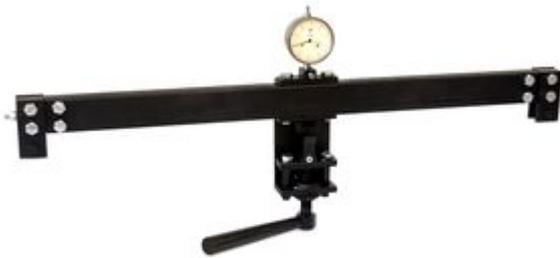
Измеритель натяжения тросов и кабелей ИНТК-5 предназначен для измерения и контроля величины усилия натяжения провода или троса при монтаже и эксплуатации ЛЭП, а также усилий в: оттяжках опор ВЛ поперечных связях, ригелях, анкерных конструкциях без разрыва силовой схемы.
