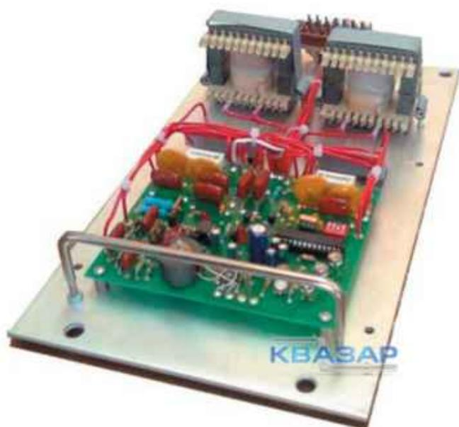
Блок управления (БУ) предназначен для работы в составе трехфазных стабилизаторов типа СТС-2 всех мощностей с фазной стабилизацией напряжения. Блок управления полностью функционален и конструктивно заменяет штатные устройства.
